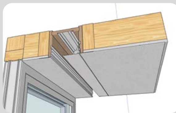
Horizontal Skim Trim / Mud in Trim (x2) L'UCH est déporté du cadre de la fenêtre, avec un plafond placo de part et d'autre.
